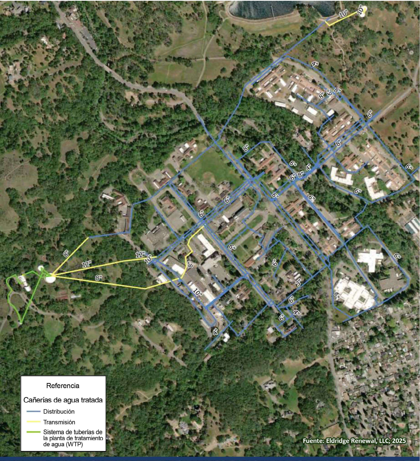
Figura 8: Red de distribución de agua
